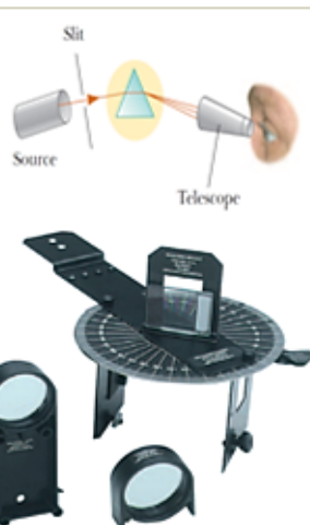
Gambar 8.14 (a) Warna-warna dalam spektrum dilihat melalui teleskop. (b) bagian-bagian spektrometer prisma (Serway & Faughn, 2002, p. 738).
