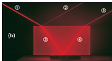
Gambar 8.6. (a) Sinar datang miring pada antarmuka udara-kaca. Sinar bias dibelokkan ke arah normal karena v_2 < v_1 . (b) Cahaya datang pada balok kaca membelok ketika memasuki balok dan ketika meninggalkan balok (Serway & Jewett, 2014, p. 1065).
