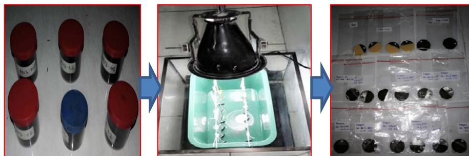
Gambar 2. Tahapan Pelapisan PANi/SiO 2 /Acrylic Paint pada plat
