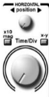
Gambar 6 Panel Pengatur Horizontal dan time/div
