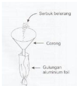
Gambar 1. Cara memasukkan serbuk belerang
