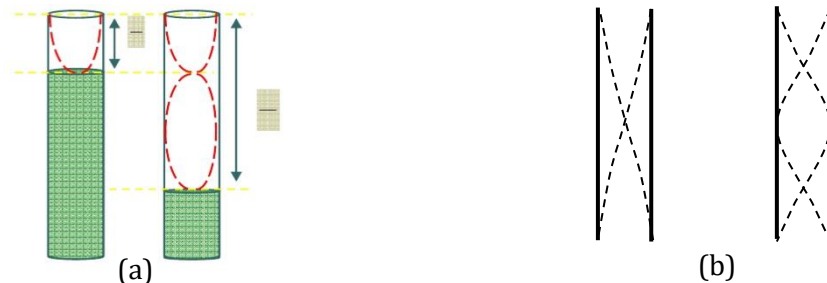
Gambar 5.1. Pola gelombang stasioner pada pipa tertutup (a) dan terbuka (b)
